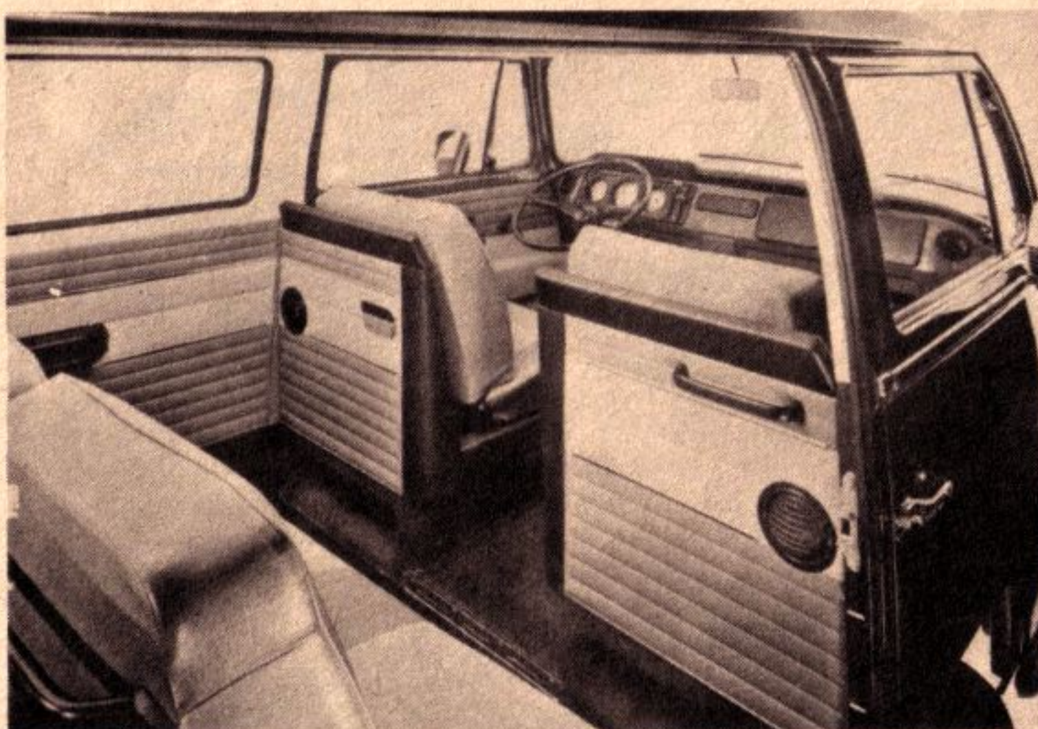
Bild 8 Die Vorderpartie des Clipper-Innenraumes zeigt eine personenkraftwagengemäße Ausstattung. Handleisten und Wände sind gepolstert. Warmluftzufuhr in den Fußraum
