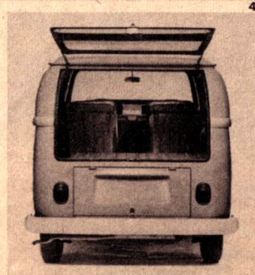
Bild 4 Blick in das Fahrzeug durch die geöffnete Heckklappe. Einzelsitze mit Durchgang sind bei geschlossenen Aufbauten serienmäßig. Durch die leicht angehobenen Stoßstangen wurde der Motorraumdeckel etwas niedriger
