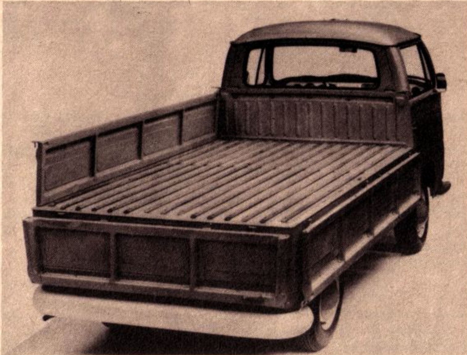
Bild 5 Pritschenwagen mit Stahlblech-Bordwänden. Zwischen den Achsen liegt ein zusätzlicher, allseitig verschlossener Laderaum von 0,7 m 3 bei 2,1 m 2 Grundfläche
