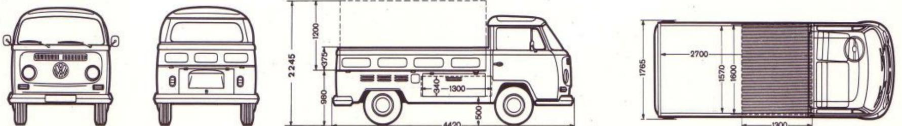
Leergewicht ohne/mit Plane (einschl. Fahrer) 1260/1295 kg; Nutzlast ohne/mit Plane (je nach Lastverteilung) bis zu 1000/965 kg.
