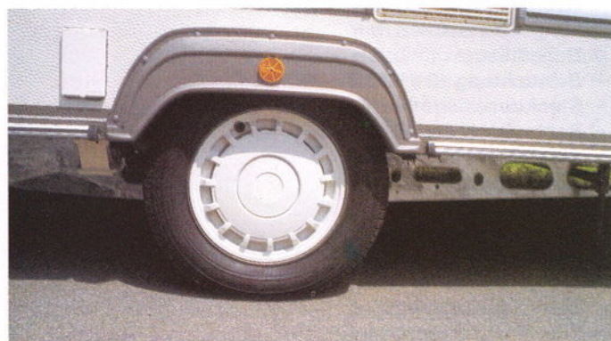
Breitspurfahrwerk mit Einzelradaufhängung.
