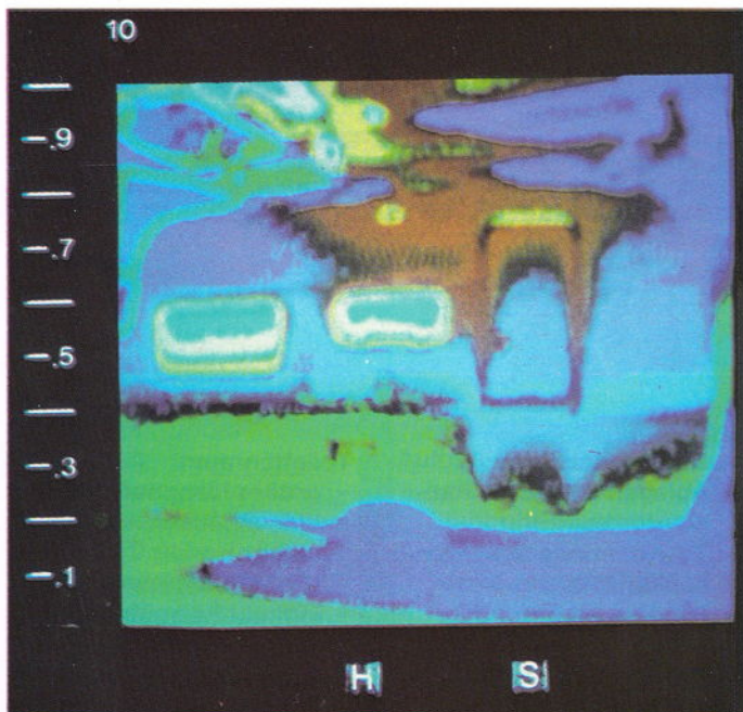
Die thermografische Untersuchung zeigt die guten Isolationswerte des PUAL-Systems.
