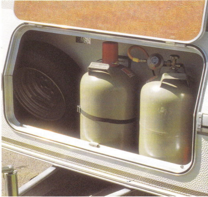
Integrierter Deichselkasten, großräumig mit Platz für 2 x 11 kg Gasflaschen, Reserverad und vielen Utensilien.
