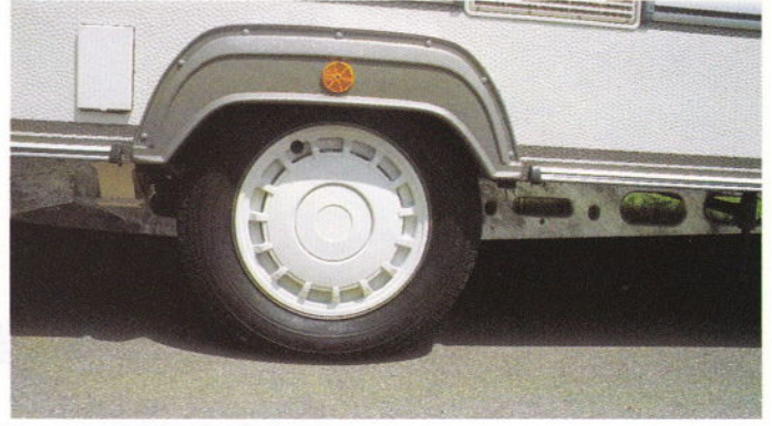
Breitspurfahrwerk mit Einzelaufhängung.
