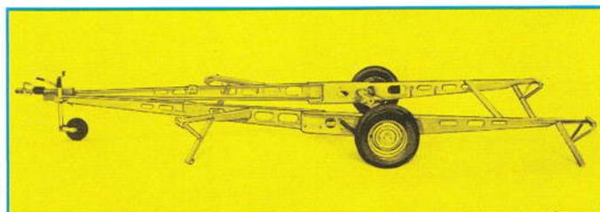
Stabiles, vollverzinktes Leichtbauchassis der Nova-Modelle mit Querverstreife im Heckbereich für hohe Stabilität des Fahrwerks und des Aufbaus.
