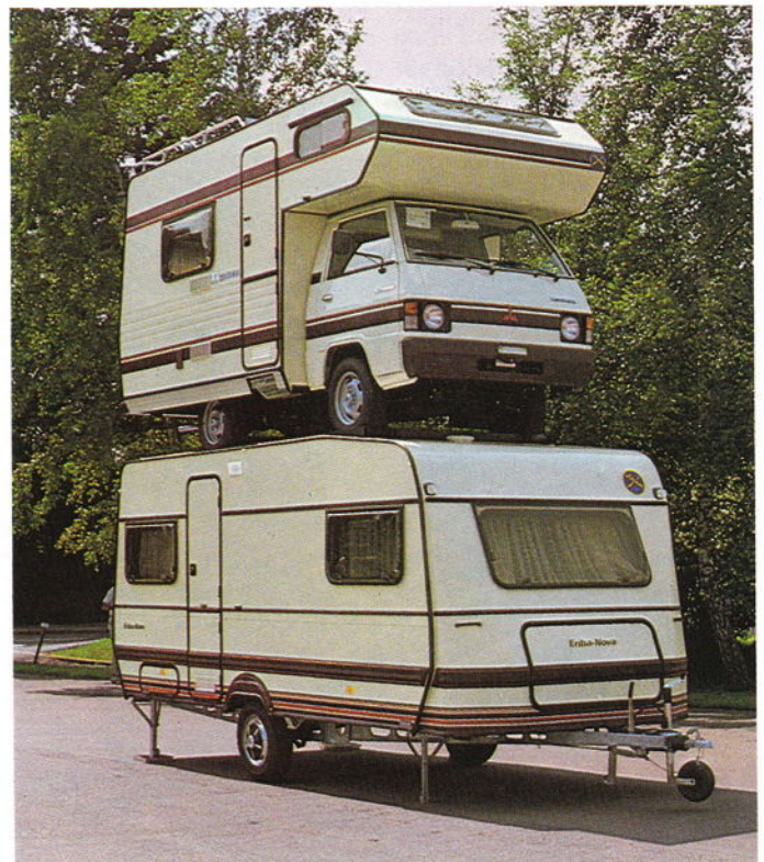
1720 kg trägt dieser Eriba-Nova Caravan. Beweis der stabilen PUAL-Bauweise.
