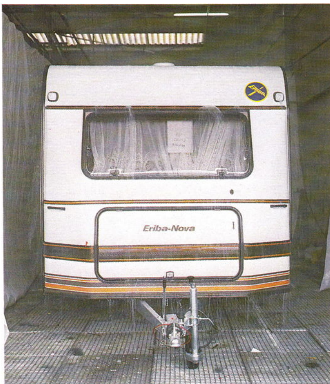
Dichtigkeitsdauertest in der Beriesungsanlage.
