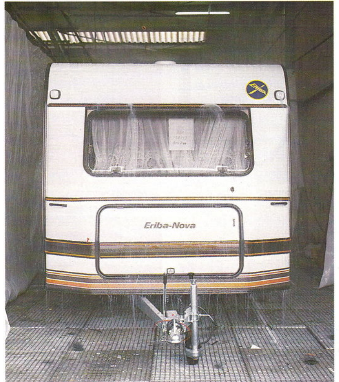
Dichtigkeitsdauerstest in der Berleselungsanlage.
