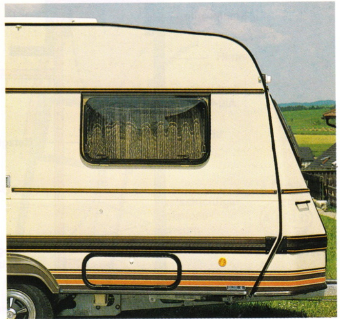
Die neue aerodynamische Frontpartie der Nova-Modelle mit integriertem Deichselkasten.
