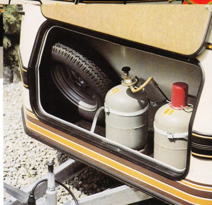
Integrierter Deichselkasten, geräumig, mit Platz für 2x11 kg Gasflaschen, Reserverad und viel Utensilien.
