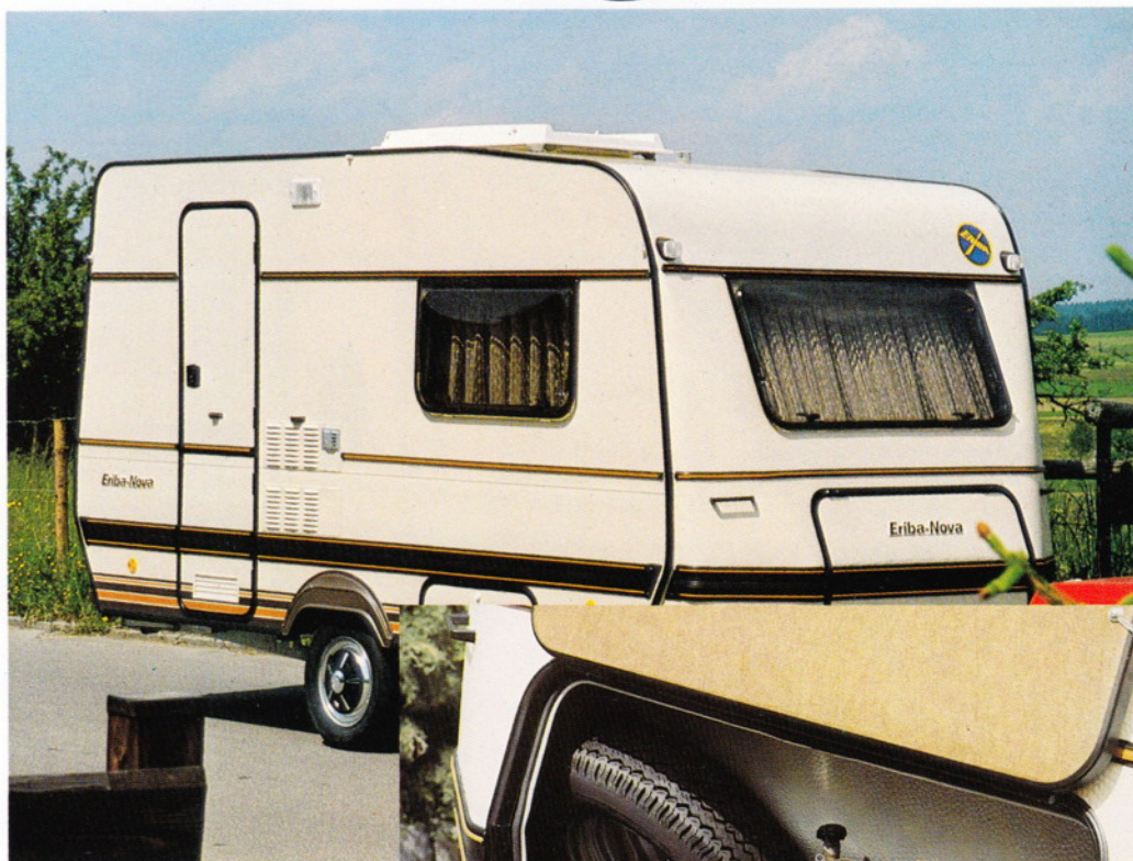
Integrierter Deichselkasten, geräumig, mit Platz für 2x11 kg Gasflaschen, Reserverad und viel Utensilien.
