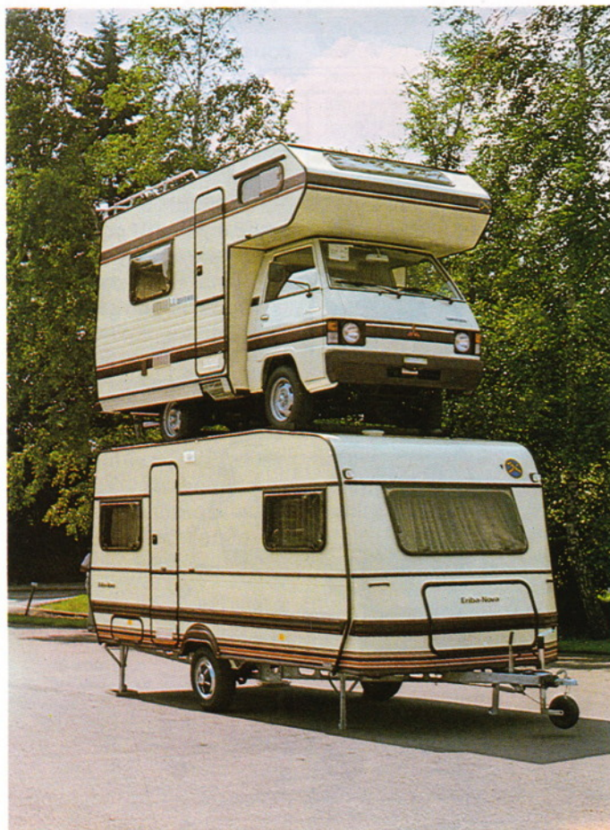
1720 kg trägt dieser Eriba-Nova-Caravan. Beweis der stabilen PUAL-Bauweise.
