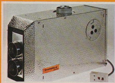
Die Elektronik ist das Herz der neuen Trumatic-E-Heizung. Die Aufstellung der Heizung ist in jeder beliebigen Lage möglich. Die kombinierte Abgas-Zuluftführung kann wahlweise über Dach, durch den Boden oder die Wand erfolgen. Das eingebaute, nahezu geräuschlos arbeitende Gebläse fördert bei minimaler Batteriebelastung sowohl die zur Verbrennung notwendige Zuluft, die von außen herangeführt wird, als auch die Umluft, die Wärme an die erforderliche Stelle transportiert.
